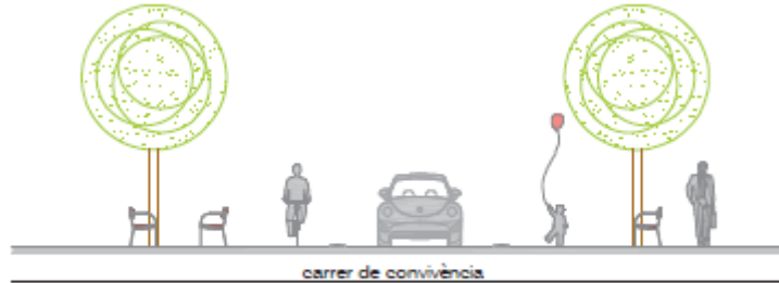
Figura 3. Exemple de carrer de convivència (B). Carrer de 12-18 metres d'amplada.
