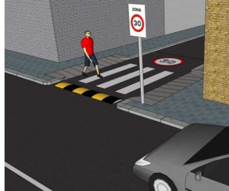
Pas amb plataforma reductora i pintura de Z30
