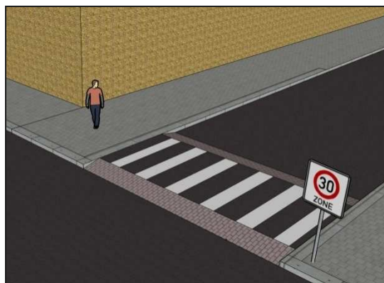
Imatge 1.2.2 Elevació de cruïlles amb passos de vianants de ressalt com a portes d'entrada a carrers estrets i de caire veïnal. Font: Elaboració pròpia.
