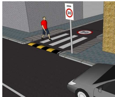
Pas amb plataforma reductora i pintura de Z30
