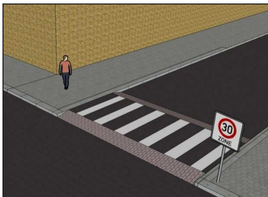
Imatge 1.2.3 Elevació de cruïlles amb passos de vianants de ressalt com a portes d'entrada a carrers estrets i de caire veïnal. Font: Elaboració pròpia.
