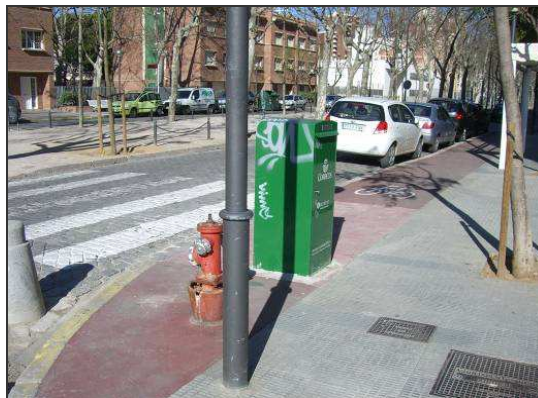
Imatge 4.1.21 Vorera amb vorera bici ocupada per hidrants, enllumenat, bústies i arbrat.
